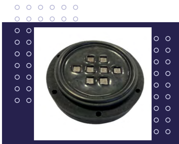
Module multi-capteurs avec électrodes en diamant pour le contrôle in-situ de la qualité des eaux ©DIAMSENS
