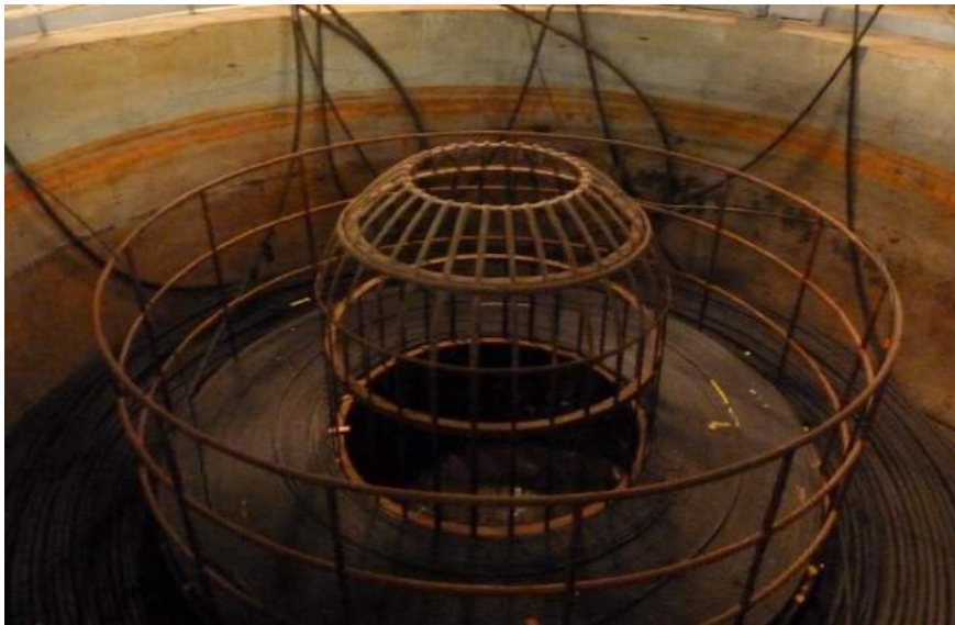
Dépôt des réserves de câbles sous-marins posés par l'armateur Orange Marine.
