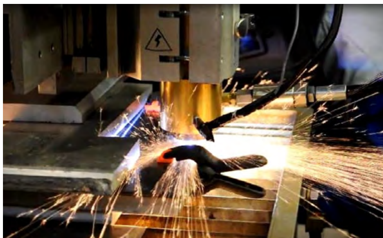
Torche de coupure automatique Akryvia en fonctionnement
