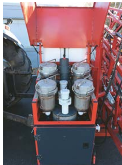
Avec DODI, les bidons d'origines remplaceront les cuves et les produits seront dosés en temps réel dans les parcelles.
