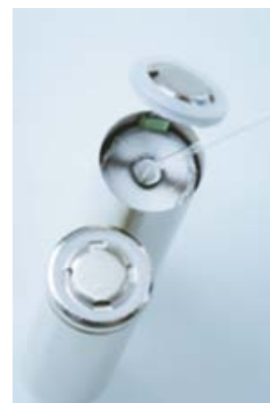
Zoom à l'intérieur d'une batterie au sodium-ion
