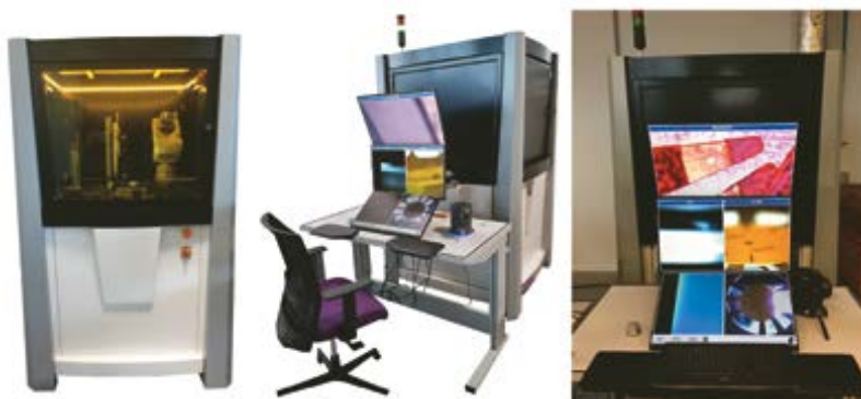
Machine robotisée avec des interfaces de l'industrie 4.0, ici pour l'assemblage et la soudure laser d'appliques sur cadran de montre
